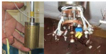
真空容器(左)とその内部の測定試料(右)
