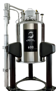
図3 冷凍機を用いた NMR マグネット用寒剤蒸発抑制装置“CR-80”(600MHz 機に設置)。He と N 2 両方に対応。基本的に補充は不要。冷凍機由来振動の影響もない。設置高さを抑える構成になっている 5) 。
