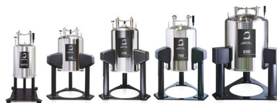
図1 JASTEC NMR 超電導磁石シリーズ。400 MHz (9.4T)から100 MHzごとに800 MHz (18.8 T)まで商用機として製品化されている。システムメーカーの日本電子株式会社殿(JEOL)へのOEM販売となっている。
