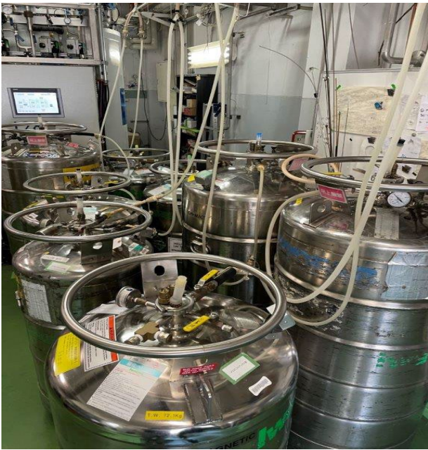
図2 民間企業から受け入れたNMR装置等へヘリウム納入後の残りのヘリウム液体が入った容器の写真。この日には関西地区の様々な場所からの容器が一度に集まった。
