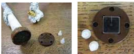
図6：RF-SQUIDとResonatorホルダ
