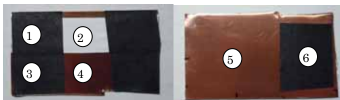
図 1. 銅板に各種フィルムを貼った測定サンプル。 白抜き丸数字の部分が測定位置。
