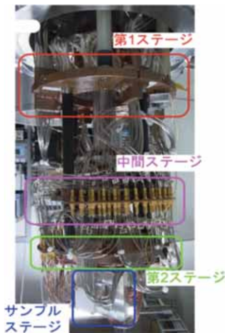
図 2. 冷凍機内部の写真。
